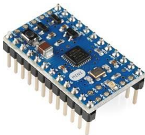
รูปที่ 1.22 ไมโครคอนโทรลเลอร์ Arduino Mini (ที่มา www.Thaieasyelec.com )
