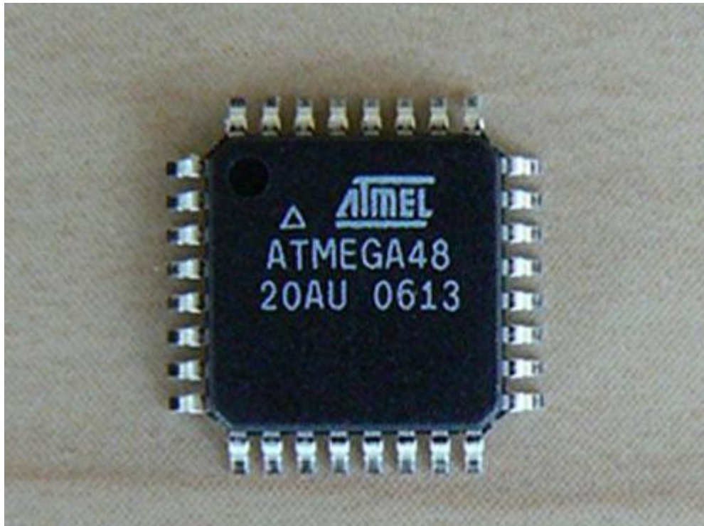
รูปที่ 1.16 ไมโครคอนโทรลเลอร์ Atmega48 (ที่มา www.Chinaimportexport.Wikispaces.com )
