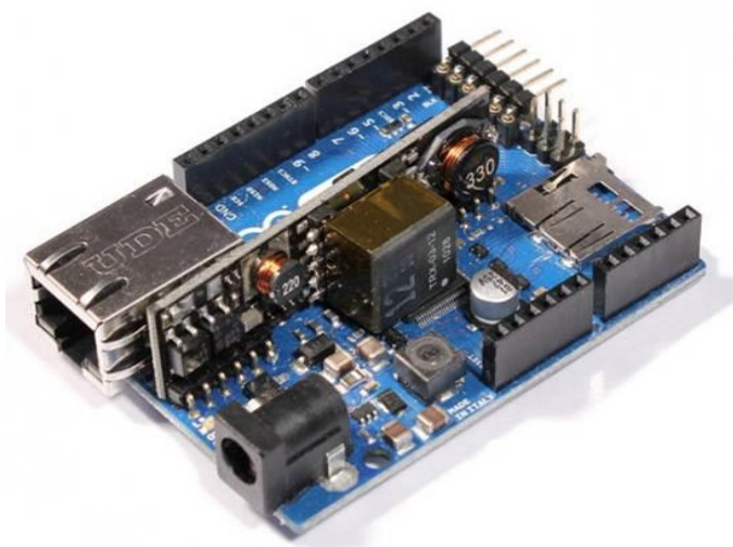
รูปที่ 1.25 ไมโครคอนโทรลเลอร์ Arduino Ethernet with PoE Module (ที่มา www.Thaieasyelec.com )
