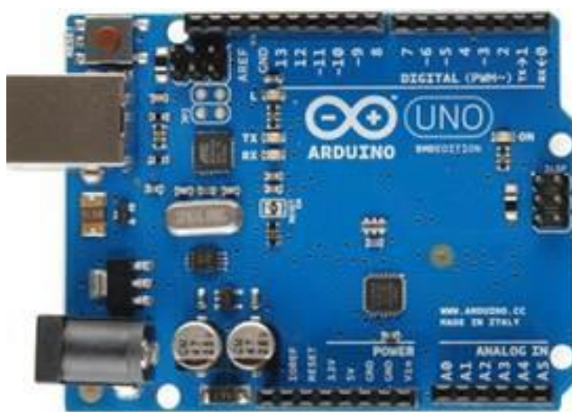
รูปที่ 1.18 ไมโครคอนโทรลเลอร์ Arduino Uno SMD (ที่มา www.Thaieasyelec.com )
