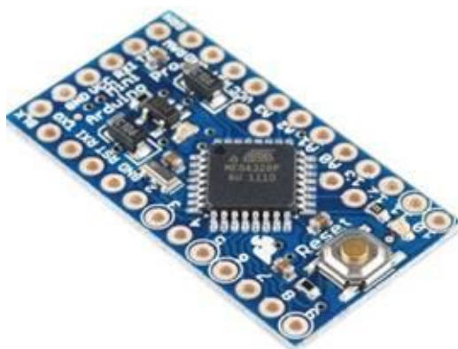
รูปที่ 1.23 ไมโครคอนโทรลเลอร์ Arduino Pro Mini 328 3.3V (ที่มา www.Thaieasyelec.com )
