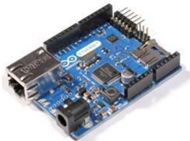
รูปที่ 1.26 ไมโครคอนโทรลเลอร์ Arduino Ethernet without PoE module (ที่มา www.Thaieasyelec.com )
