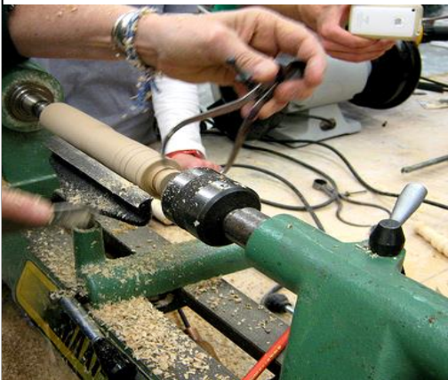
รูปที่ 5.29 การขยายคาลิเปอร์ขาวัด ทางออกใหญ่กว่าเส้นผ่าศูนย์กลางของงาน
