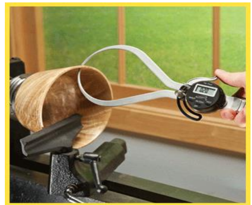
รูปที่ 5.10 การขยายคาลิเปอร์ ขาวัดทางออกเล็กกว่าศูนย์กลางของงาน
