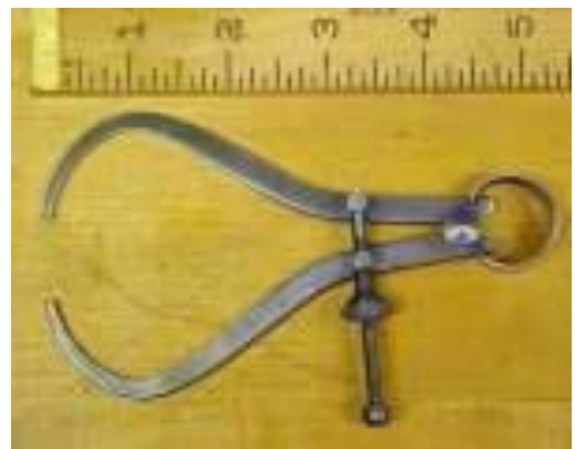
รูปที่ 5.32 การเปรียบเทียบขนาด คาลิเปอร์จากบรรทัดวัด
