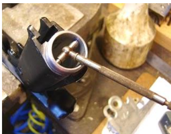
รูปที่ 5.73 นำเกจวัดออกจากรูชิ้นงาน
