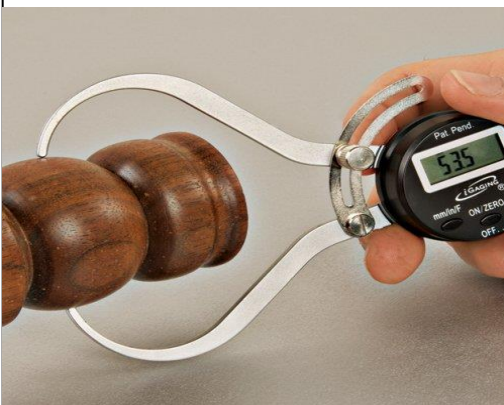
รูปที่ 5.31 การขยายคาลิเปอร์ขาวัด ทางออกพอดีกับเส้นผ่าศูนย์กลางของงาน
