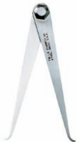
รูปที่ 5.40 คาลิปเปอร์วัดในแบบใช้ความฝืด
