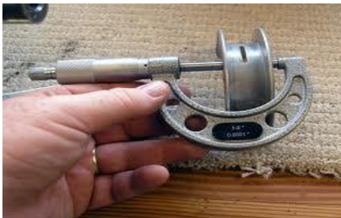
รูปที่ 3.47 การใช้ไมโครมิเตอร์ และความหนาของท่อ
