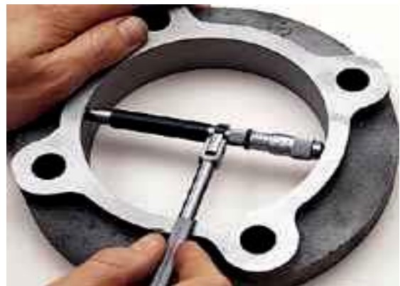
รูปที่ 3.86 การใช้ไมโครมิเตอร์วัดใน วัดงานแบบต่างๆ
