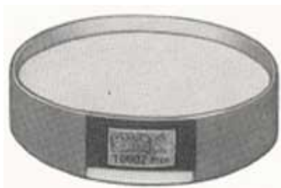
รูปที่ 3.34 แผ่นแก้วตรวจสอบความราบเรียบของหน้าสัมผัสของแกนวัดไมโครมิเตอร์
