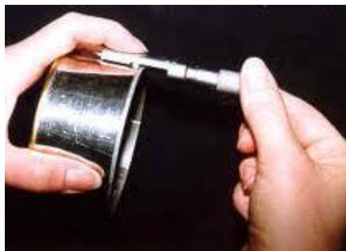
รูปที่ 3.58 ไมโครมิเตอร์วัดมุมขอบ
