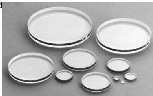
รูปที่ 3.35 แผ่นแก้วตรวจสอบความขนานของหน้าสัมผัสของแกนวัดไมโครมิเตอร์
