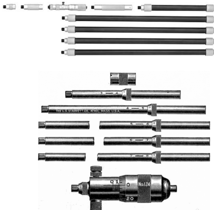
รูปที่ 3.78 ไมโครมิเตอร์วัดใน และขาต่อแบบต่าง ๆ
