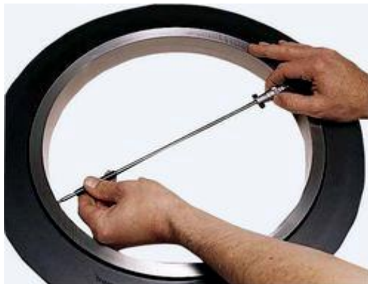
รูปที่ 3.86 การใช้ไมโครมิเตอร์วัดใน วัดงานแบบต่างๆ
